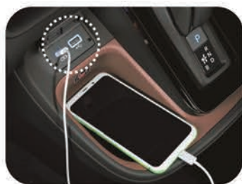
シフトサイドポケット前方 (充電用USB端子(Type-C) 1個) (通信用USB端子(Type-A) 1個)
